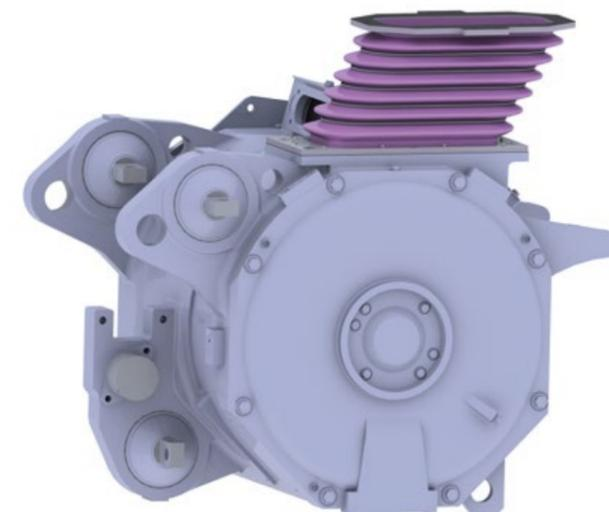
Mit Prüfvorrichtungen wird die maximal geforderte Bewegung an einem Faltenbalg eines neuen Projektes simuliert. Die Dauerhaltbarkeit der Fahrmotorbelüftungsbälge kann vor Serienstart, gegen Berechnung, in Prüfvorrichtungen mit vorab definierter Bewegungsmatrix über einen festgelegten Zeitraum getestet werden. Dabei wird auch das Verschleißverhalten bei unterschiedlichen Einbaulängen und Verformungsabläufen geprüft.
