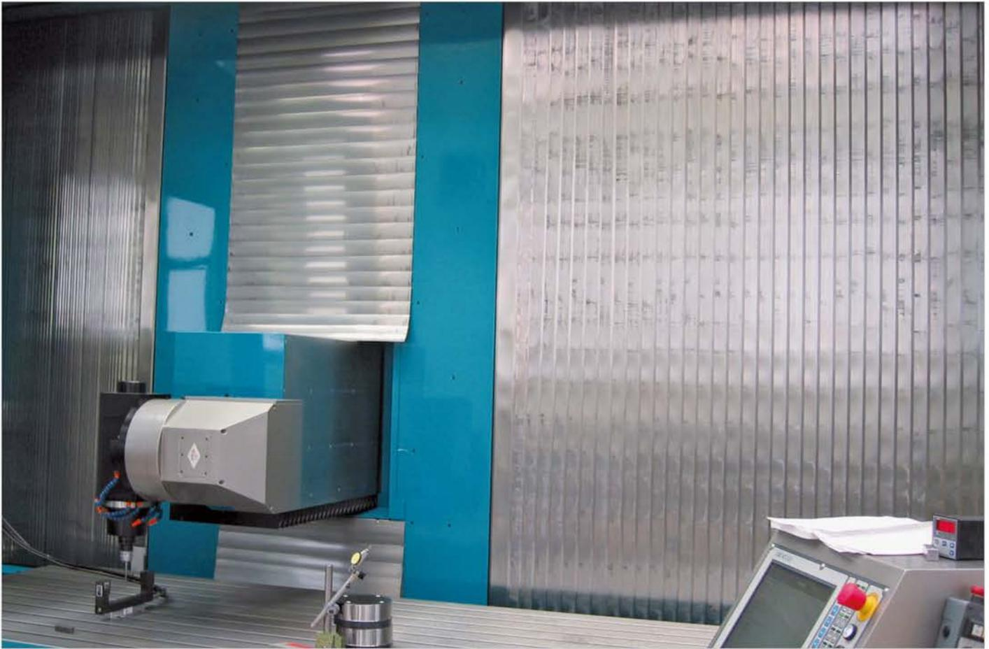
Ansicht einer Fahrständermaschine
