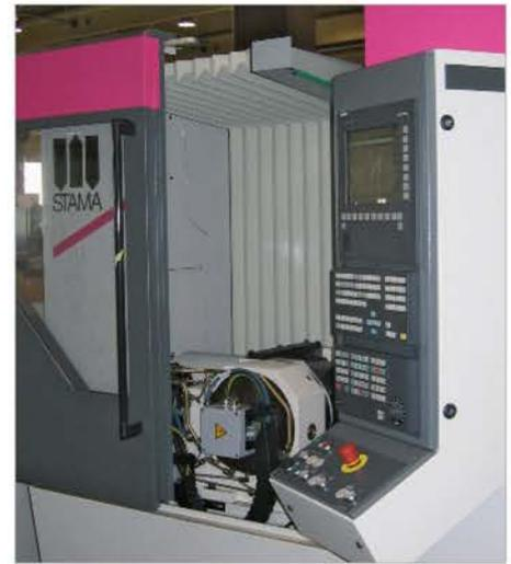
Kombifaltwand in einer Kompaktmaschine
