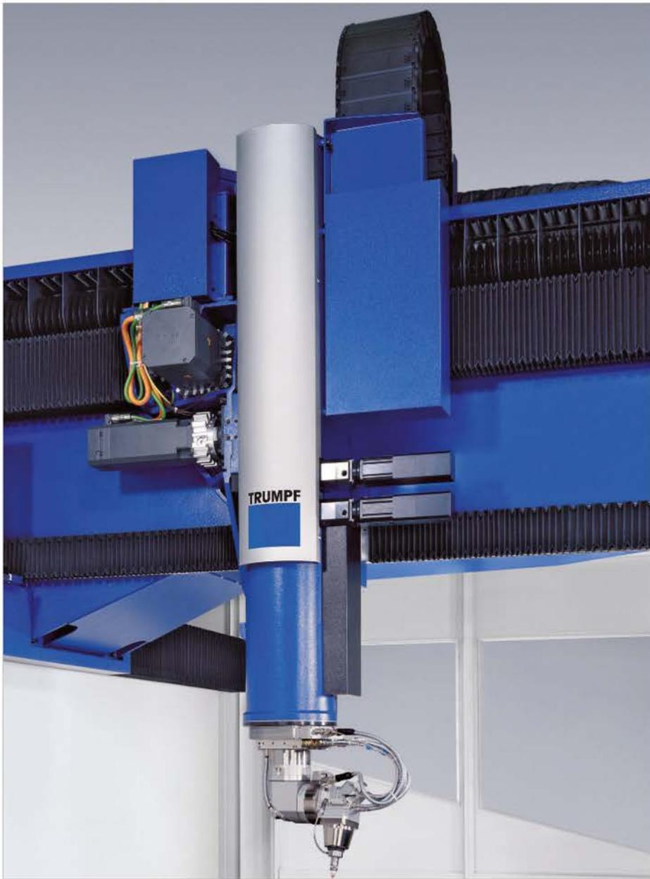
Strahlführungsbälge in einer Lasermaschine
